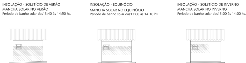
Figura 19 – Insolação na parede ao longo das estações do ano
