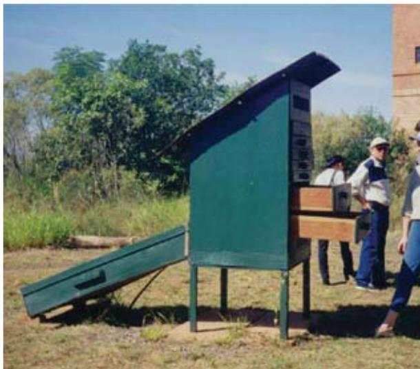
Figura 55 – Secador solar do Rincão Gaia
