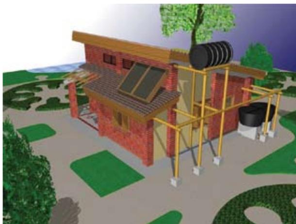
Figura 50 – Sistema de coleta de água de chuva
