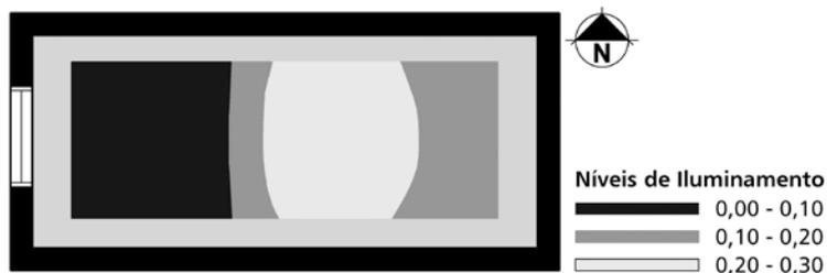
Figura 202 – Distribuição da iluminação natural no interior do banheiro
