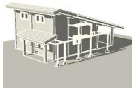
Figura 208 – Visualização da nova proposta, com o deslocamento do alpendre lateral para a fachada norte e modificação no telhado
