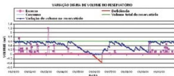
Figura 327 - Variação diária do volume do reservatório segundo balanço hídrico seriado (OLIVEIRA, 2003)
