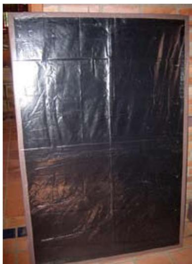
Figura 237 – Placa coletora com lona plástica
